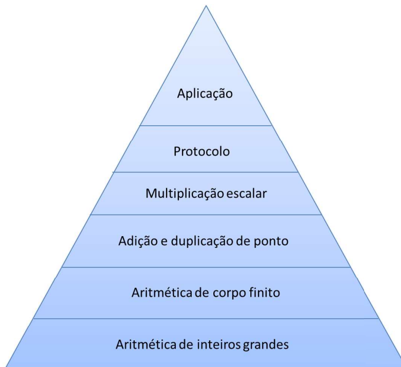
Figura 3.12: Pirâmide de implementação de criptografia baseada em curvas elípticas (ECC). Qualquer uma destas camadas pode ser vulnerável a ataques por canais laterais.
